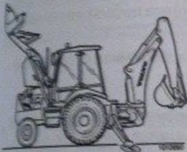
Положение для обслуживания 1 Обратная лопата в положении транспортировки, стрела погрузчика поднята.
