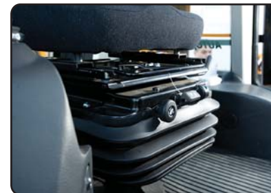
Вентилируемое кресло оператора настраивается по высоте в соответствии с весом оператора посредством сжатого воздуха.
